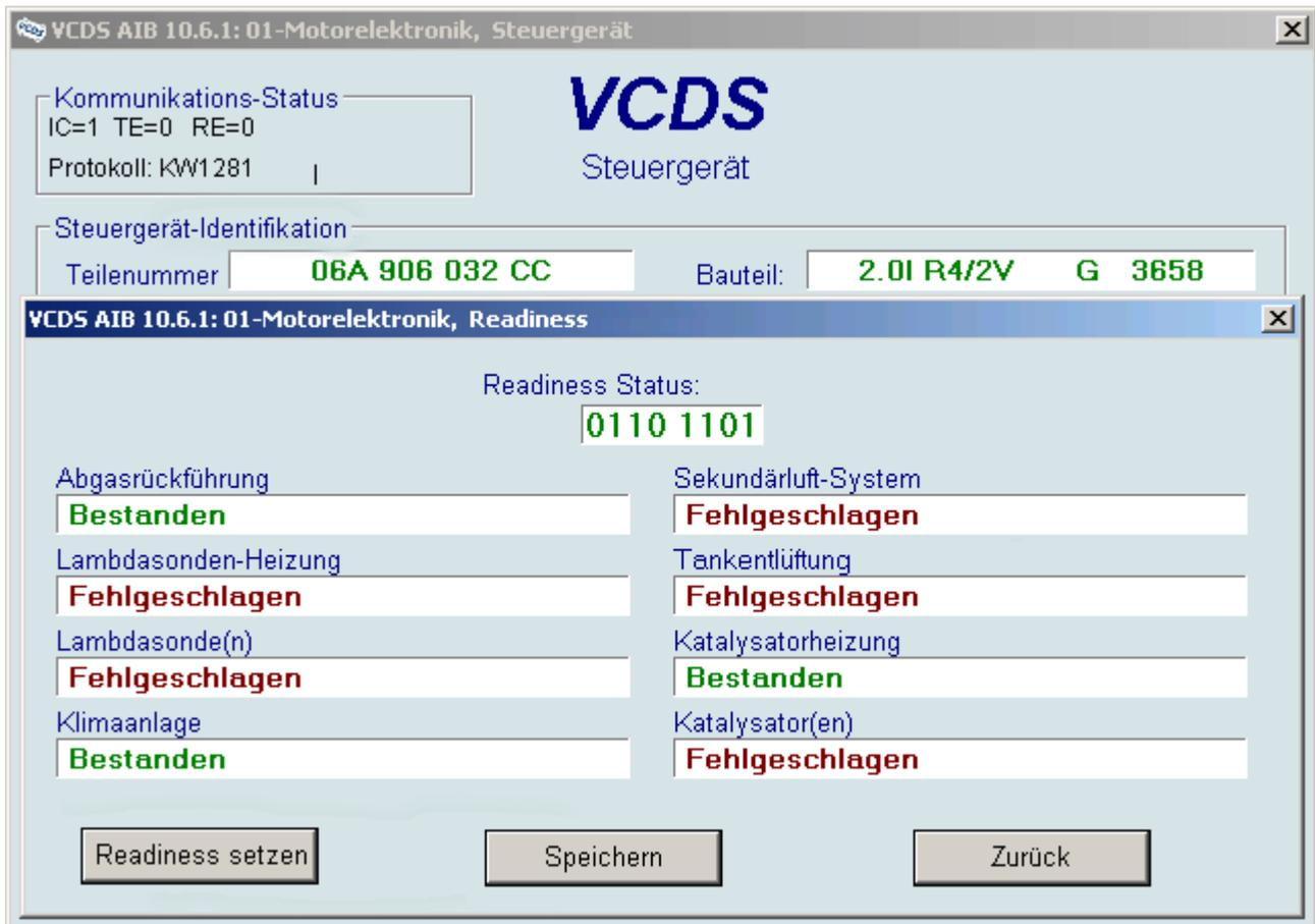
Die Readiness-Prüfung ermöglicht es, bei OBD- bzw. OBD2-konformen Fahrzeugen die Funktionsbereitschaft von 8 abgasrelevanten Fahrzeugsystemen abzufragen. Ergebnis dieser Abfrage ist der 8-stellige Readiness-Code, von denen jede Stelle einem überwachten System entspricht. Wenn alle Systeme "Bestanden" anzeigen, heißt das, daß alle Systeme die vorgeschriebenen Funktionstests bestanden haben.
