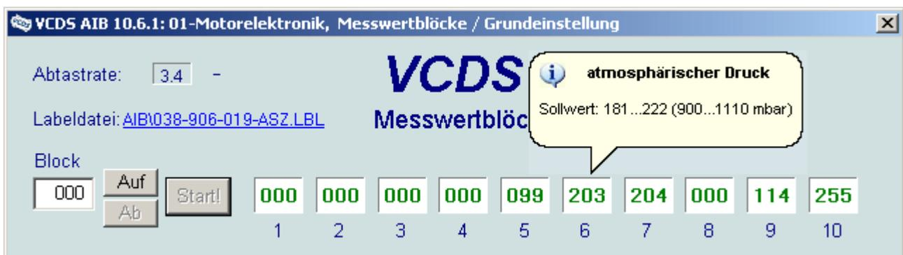
**Abtastrate:** Manche Steuergeräte liefern beim Auslesen eines einzigen Meßwertblocks selbst bei aggressivster Protokoll-Taktung nicht mehr als ca. 3,5 Messungen pro Sekunde, andere Steuergeräte ein Mehrfaches. Wenn 2 Blöcke gleichzeitig ausgelesen werden, sinkt die Abtastrate natürlich um etwa die Hälfte und bei 3 Blöcken um ca. 2/3.
