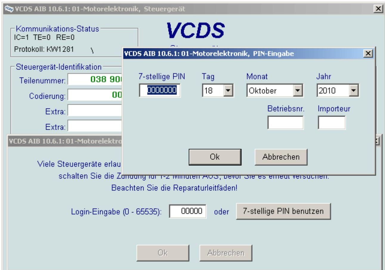
Der Dialog zur PIN-Eingabe wird für Schlüsselanpassung und Anpassung von Wegfahrsperrern ab der 3. Generation benutzt. Einzugeben sind die folgenden Daten:
